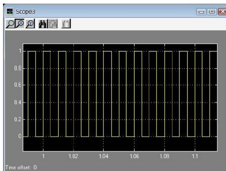
ภาพที่ 11.25 ผลการจำลองสัญญาณสุ่มตัวอย่าง f_s = 100 \text{ Hz} วัดจากสัญญาณ scope2
