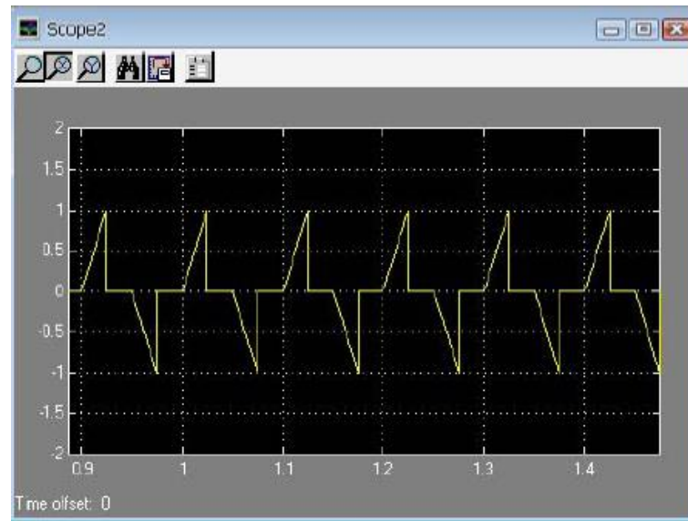
ภาพที่ 11.27 ผลการจำลองสัญญาณสุ่มตัวอย่าง f_s = 20 \text{ Hz} วัดจากสัญญาณ scope1
