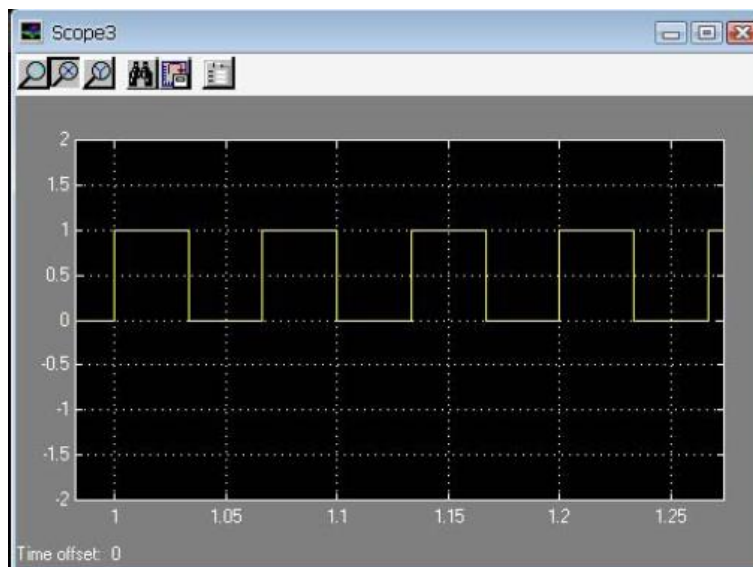
ภาพที่ 11.31 ผลการจำลองสัญญาณสุ่มตัวอย่าง f_s = 15 \text{ Hz} วัดจากสัญญาณ scope2
