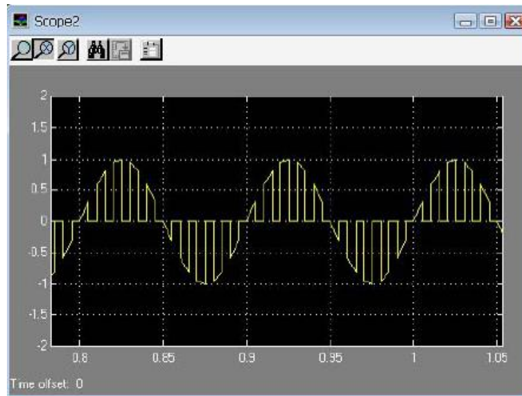
ภาพที่ 11.24 ผลการจำลองสัญญาณสุ่มตัวอย่าง f_s = 100 \text{ Hz} วัดจากสัญญาณ scope1
