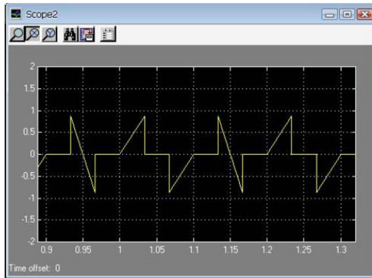
ภาพที่ 11.30 ผลการจำลองสัญญาณสุ่มตัวอย่าง f_s = 15 \text{ Hz} วัดจากสัญญาณ scope1
